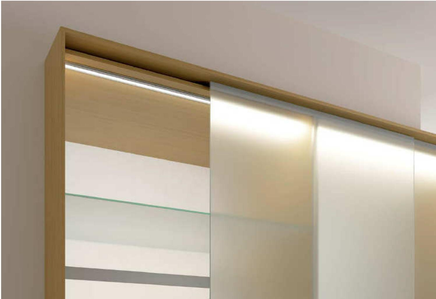
Die GERA Profileinbauleuchte ist eine lineare Lichtquelle, deren Konzept auf Helligkeit, Flächenbündigkeit und dabei auf totale Blendfreiheit setzt. Das Leuchtenprofil taucht dafür tief in die Möbelplatte ein und sendet schräg gerichtetes Licht in Richtung der Schrankrückwand. Es wird als indirektes Licht in den Schrankraum reflektiert.
